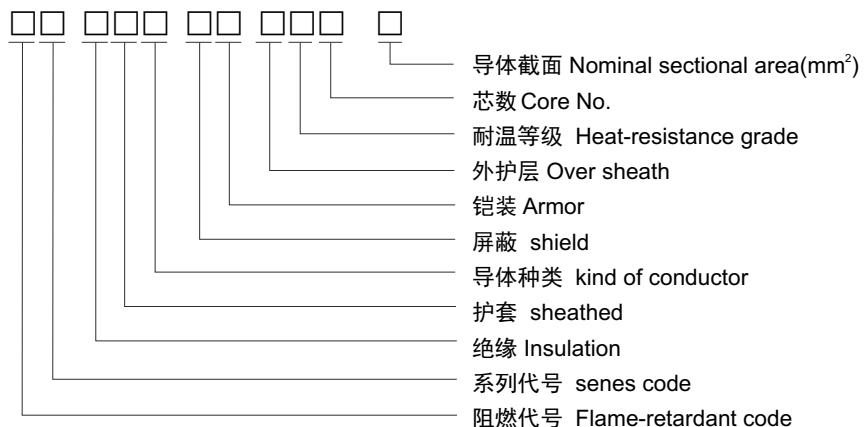
注: ( ) 表示导体截面积在10mm<sup>2</sup>以下时非软结构电缆的导体种类,A表示单根导体,可省略,B-绞合导体。
