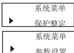
保护整定项目主要用来选择电动机所需投入的保护种类、各种保护的具体参数。
