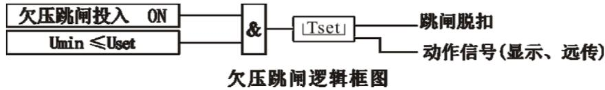
图 34 欠压跳闸逻辑图
