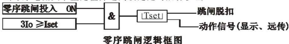
跳闸显示值为：零序电流/额定电流。
