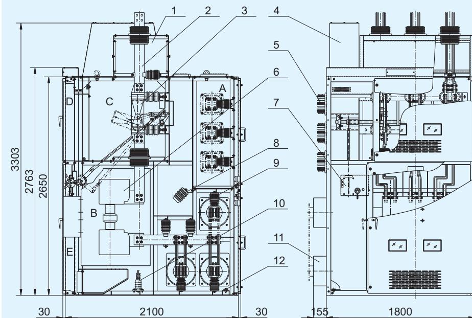
A、主母线室    B、断路器室    C、隔离开关室    D、仪表室    E、操作室
